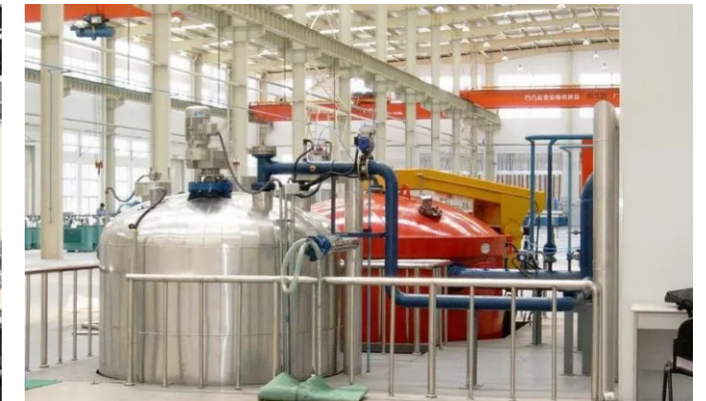
■ VPI真空压力沉浸
